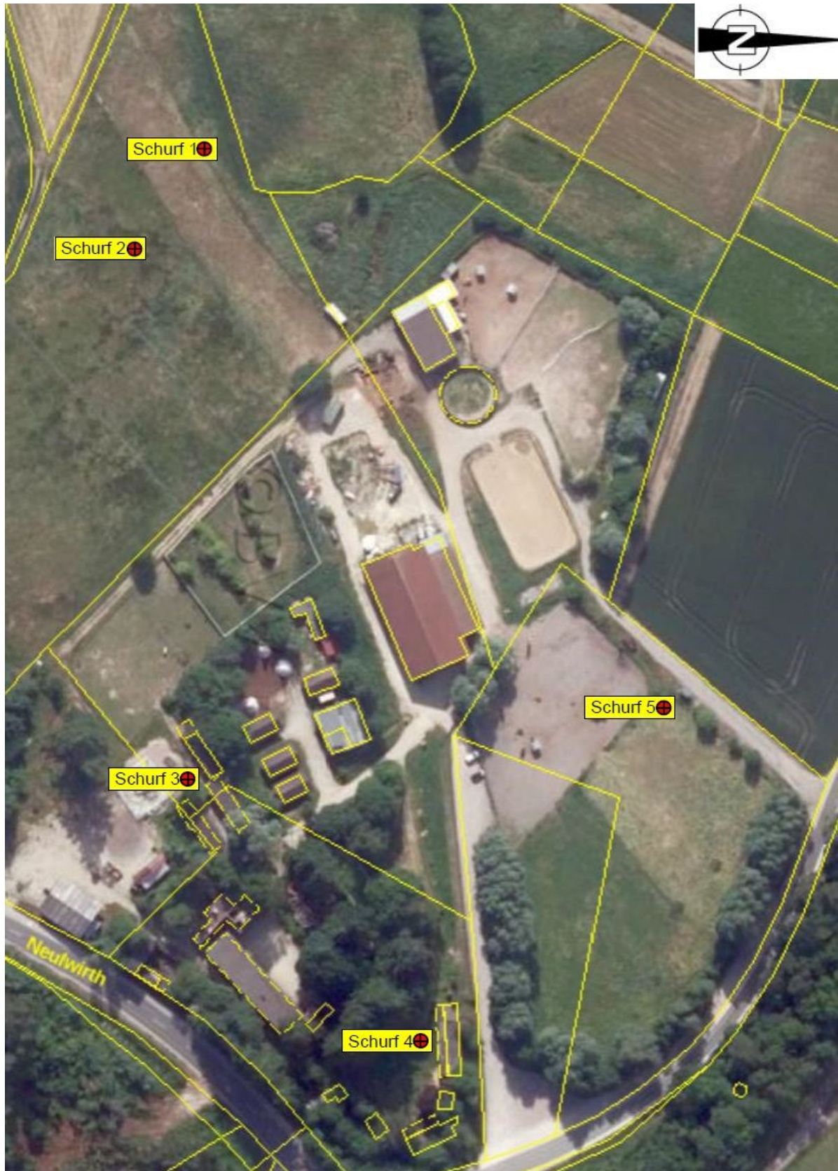
Lage der Schürfe mit den durchgeführten Versickerungsversuchen (Grundbaulabor Aichach 2024)
